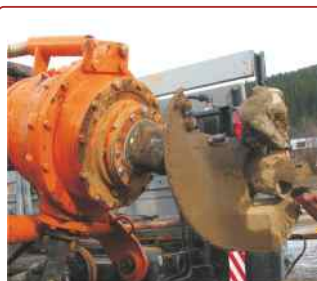
Kopaczka jam MRK-750, głębokość wiercenia – 3 m, średnica – 0,75 m
