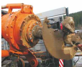
Ямобур МРК-750, глибина буріння – 3 м, діаметр – 0,75 м.
